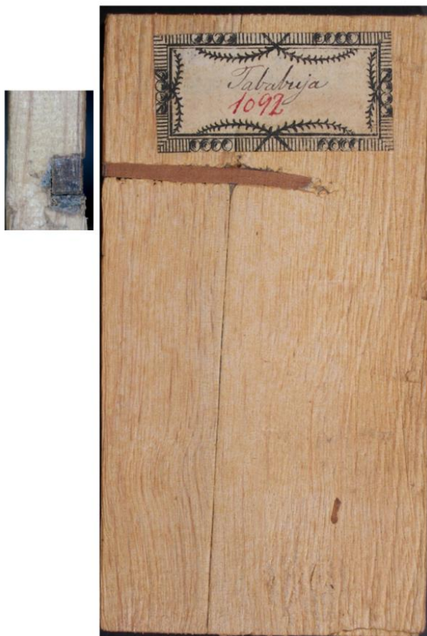
Figura 6. Amostra 1092 ('Tababuja') mostrando o uso de respiga para reforço da ligação colada entre duas peças.
